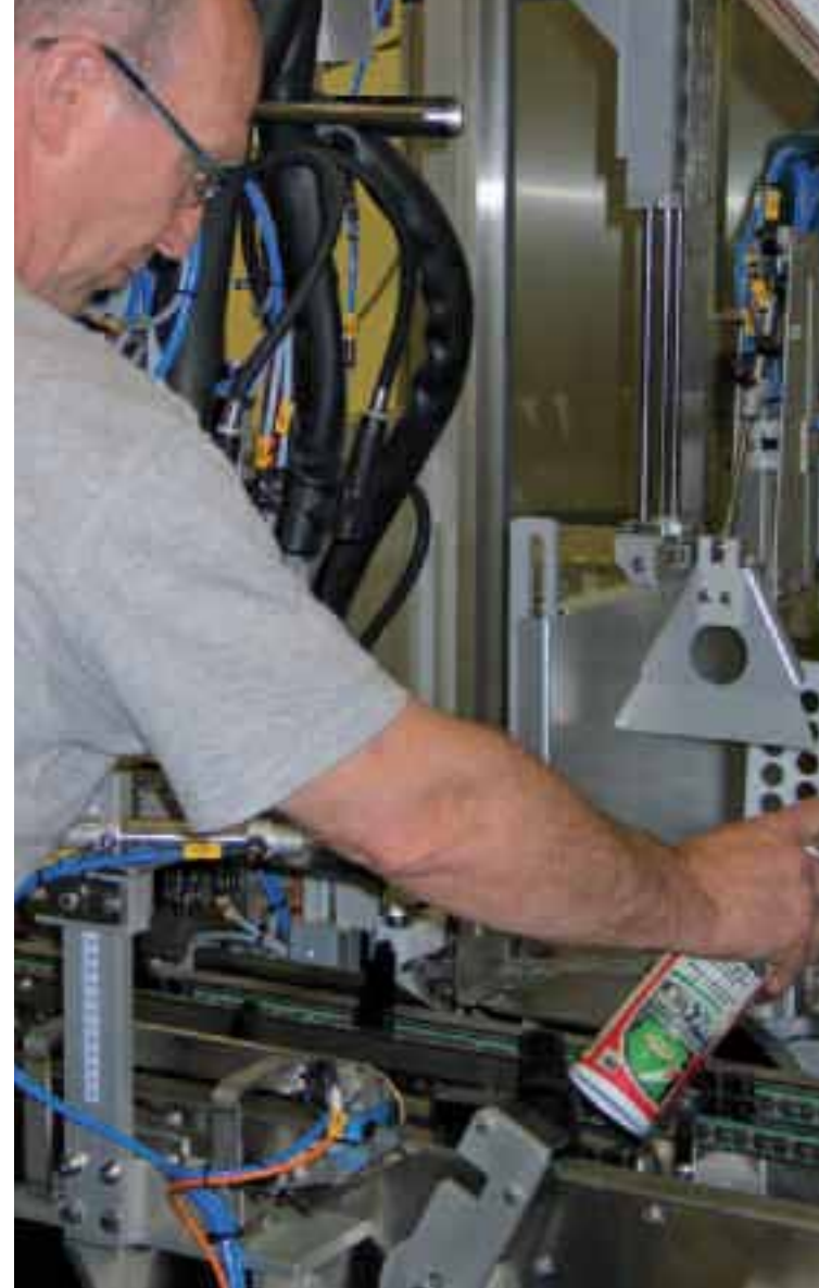
Onderhoud aan de WA-machine (lees: wrap around-machine). Een machine voor het verpakken van de 1 liter pakken in om dozen.
