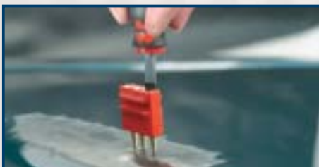
5. Met schroevendraaier de pin losdraaien.
