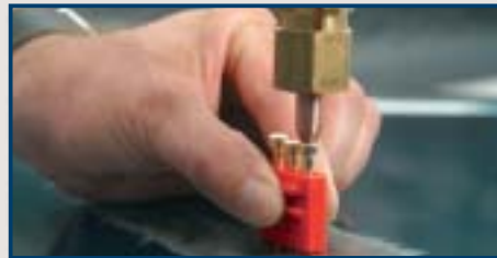
2. Koper elektrode op de pin plaatsen en vastlassen.
