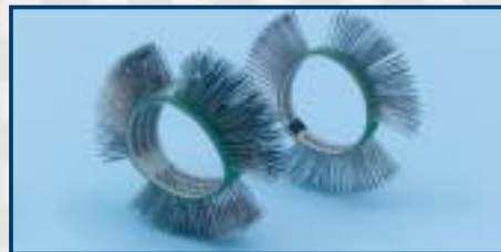
Fijne borstelband 23 mm Art.nr. 0703 350 3 Verp. per: 5 Fijne borstelband 11 mm Art.nr. 0703 350 31 Verp. per: 5 Hierbij verkrijgt men een glad oppervlak. Verenstaal Ø 0,5 mm, recht, punten gehard. Toepassing: verwijderen beschermak van nieuwe carrosseriedelen en overzetplaatwerk, pakkingen op gietijzer, roest. NIET voor aluminium en alu-legeringen.
