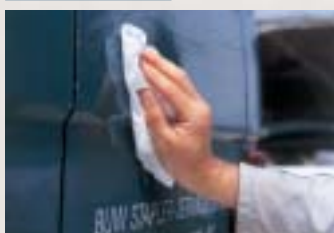
1. Deuk met acetonreiniger reinigen.
