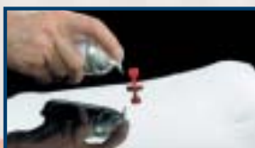
7. De smeltlijmverwijderaar in de ontstane opening spuiten, even laten inwerken en vervolgens de lijm van het lakoppervlak verwijderen.
