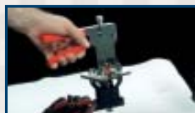
5. De minilifter op de adapter plaatsen en de deuk met gevoel omhoog halen.
