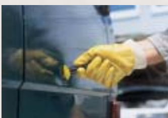
5. Met het heteluchtpistool de adapter verwarmen tot ca. 80°C en m.b.v. de handgreep de adapter wegschuiven.
