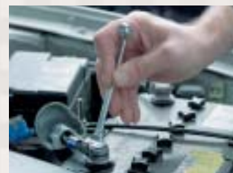
Geen accuklem losmaken ter bescherming van de elektronica.
