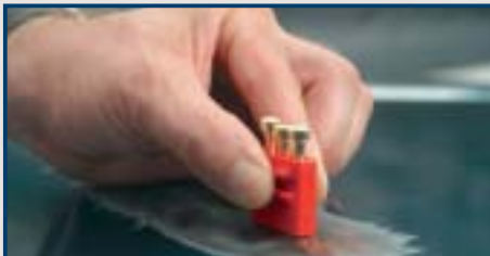
1. De pinnen op het plaatwerk plaatsen en het trekblok naar beneden drukken.
