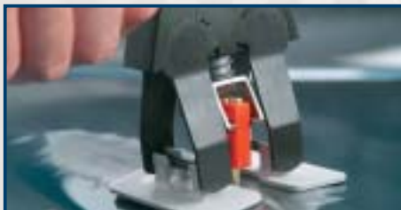
3. Pinpuller plaatsen en de deuk eruit trekken.
