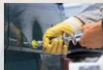
4. Slagtrekker op de adapter plaatsen en de deuk verwijderen.
