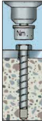
Anker met slagmoersleutel indraaien
