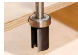
Door de volgager aan de frees kan men snel en eenvoudig frezen zonder de sjabloon te beschadigen.
