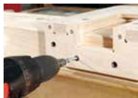
Sjabloon met schroeven op de balk bevestigen.
