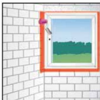
Afb. 3: Druk de folie aan met een aandrukroller
