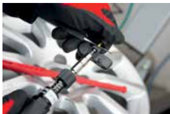
Monteren rubber ventiel aan de sensor met 1,4 Nm
