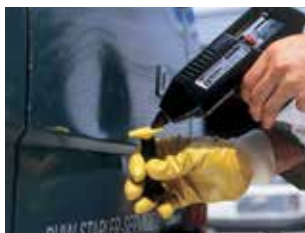
2. Juiste adapter op de handgreep plaatsen en de speciaallijm in het midden opbrengen.
