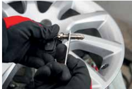
Bevestig de seal met de ring
