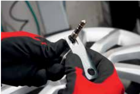
Verwijder de seal met de open vork
