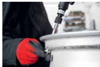
Aandraaien van de moer met 8,0 Nm bij een metalen ventiel
