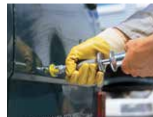
4. Slagtrekker op de adapter plaatsen en de deuk verwijderen.
