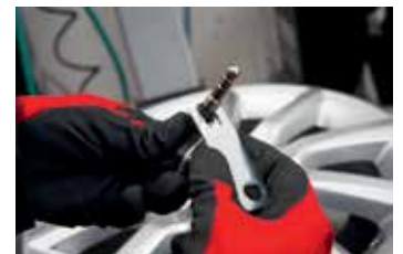
Seal verwijderen met de special tool
