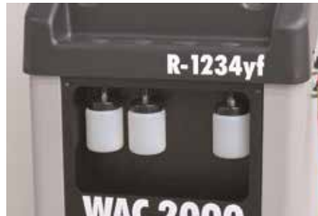
3 oliereserves voor verse olie, gebruikte olie en UV toevoegingen
