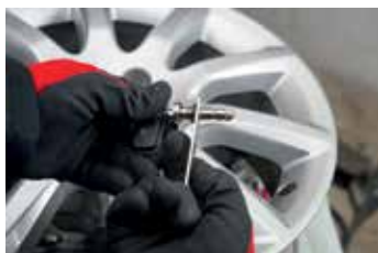
Monteren van de seal met de special tool
