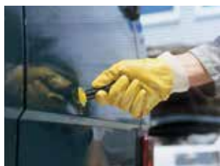
5. Met het hetelucht pistool de adapter tot ca. 150° verwarmen en m.b.v. de handgreep de adapter wegschuiven.
