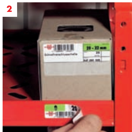
... op magazijnstelling aanbrengen
