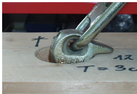
Verzinking: diepte 3 cm / Ø 70 mm
