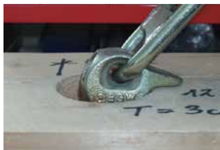
Verzinking: diepte 3 cm / Ø 70 mm
