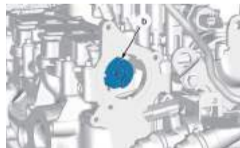
0109-2D Uitlaat nokkenas vergrendeling gereedschap
