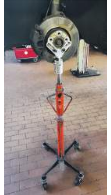
2 V-vormige houder 46° draaibaar en in middenpositie afsluitbaar
