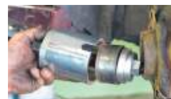
Montage wiellager – aanslag in wiellagerhuis
