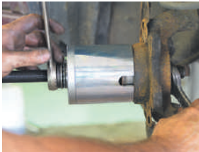
Montage wielager – aanslag in wielagerhuis
