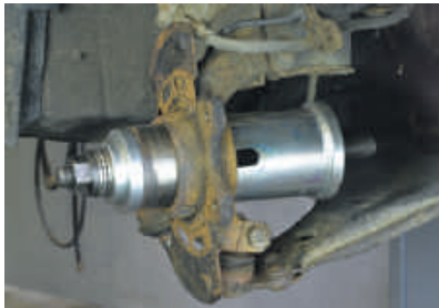
Montage wielager – aanslag in wielagerhuis
