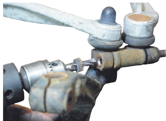
Schroefkop gescheiden van de as
