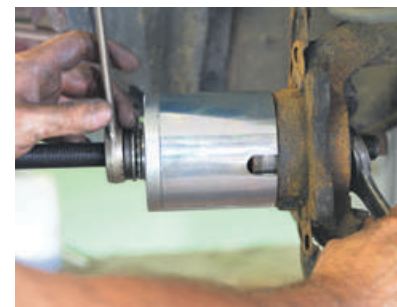
Montage wiellager – aanslag in wiellagerhuis
