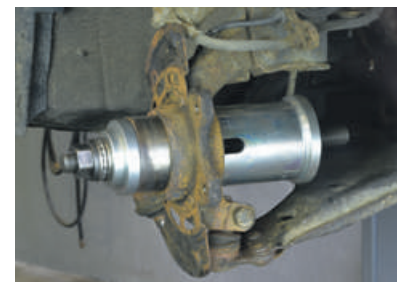
Montage wiellager – aanslag in wiellagerhuis
