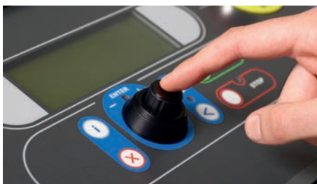
CooliusSelect: eenvoudige data invoer door nieuwe navigatie-draaiknop.
