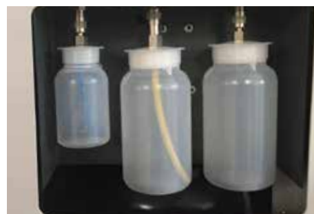
Uitgerust met 1 oliereservoir voor olie, 1 oliereservoir voor oude olie en 1 reservoir voor UV-additieven
