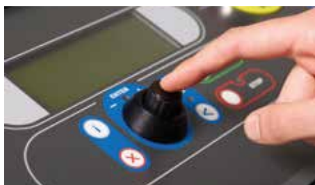
CooliusSelect: eenvoudige data invoer door nieuwe navigatie-draaiknop.
