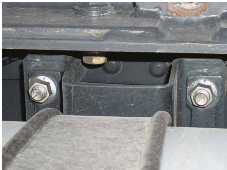
Bevestiging aan vrachtwagenchassis
