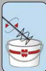
Brandwerende coating goed roeren.
