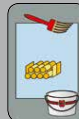
De buitenrand van de doorvoering, de kabels en kabelgoot voorzien van brandwerende coating (min 1 mm dik).
