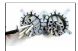
Meerdere manchetten mogen direct langs elkaar gemonteerd worden (0 mm onderlinge afstand). Vul vervolgens eventuele voegen of ruimten tussen bekabeling op met brandwerende acrylaat ACR240, art.nr. 0893 311 000. Ook bij een open doorvoer aan één zijde dienen de openingen in de bekabeling opgevuld te worden met genoemde brandwerende acrylaat ACR240.
