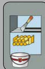
De doorvoer en snijkanten van de mineraalplaat voorzien van brandwerende coating en plaats vervolgens de mineraalplaat in de doorvoering.
