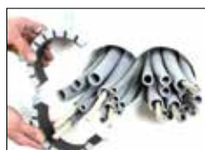
Kies vervolgens de bijpassende diameter brandwerende manchet RK I. De binnendiameter van de brandwerende manchet mag niet groter dan 30 mm zijn ten opzichte van de buitendiameter van de enkelvoudige of gebundelde kabels.
